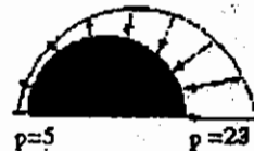
Hình 79. Đặt tải phân bố trên bề mặt phần tử
